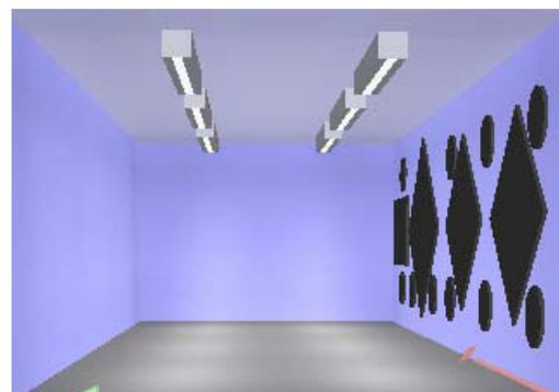
Enceinte équipée de 6 luminaires LED-1200, 8 Ronds De Gants à souder inox RDG-8040 et panneaux de vision standards à souder réduisant de 50% le linéaire de joint.
